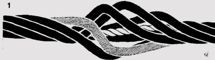
entdrilltes Drahtseil (Aufdoldung)
